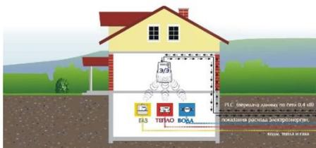
Передача данных от квартирных и общедомовых счётчиков электроэнергии до концентратора, расположенного на Трансформаторной Подстанции, осуществляется по электросети 220В с помощью технологии PLC (Power Line Communications).
